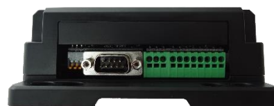
図 2 シリアルコネクタ及び GPIO/AD コネクタ側外観
