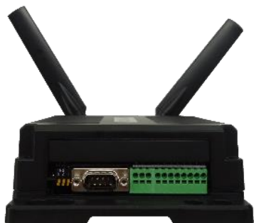
図 2 シリアルコネクタ及び GPIO/AD コネクタ側外観
