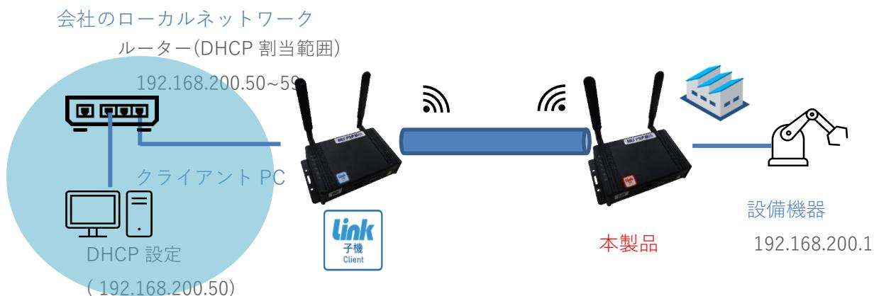
図 17 子機側のローカルネットワークの接続
