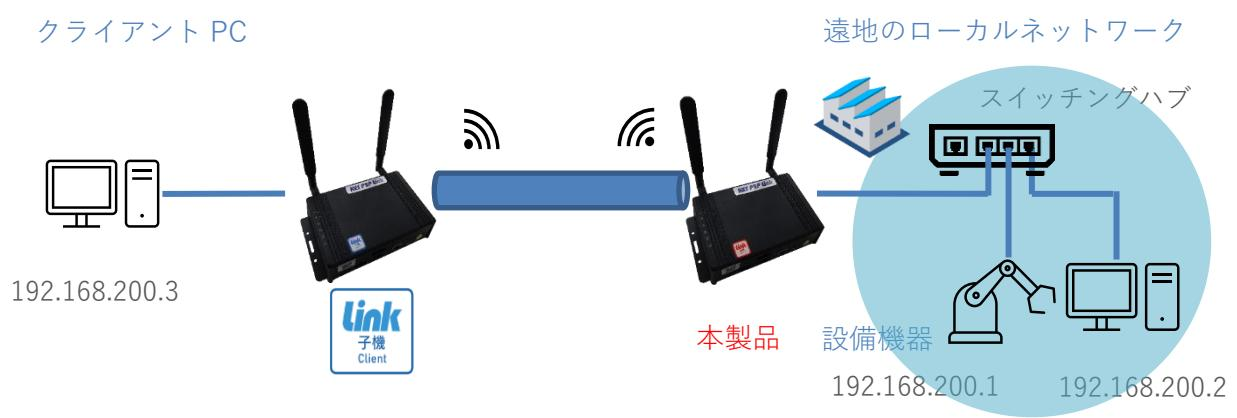
図 15 固定 IP アドレスを割り当てた PC の接続
